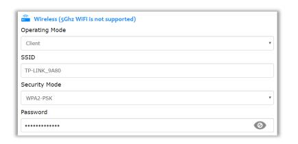
IP 配置和有线网络一致,支持 DHCP 和 Static 模式,请根据实际情况,参照有线网卡的 IP 配置说明进行修改。
