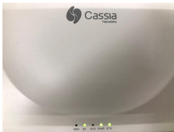
图示：使用以太网作为上联，ETH 指示灯闪烁
